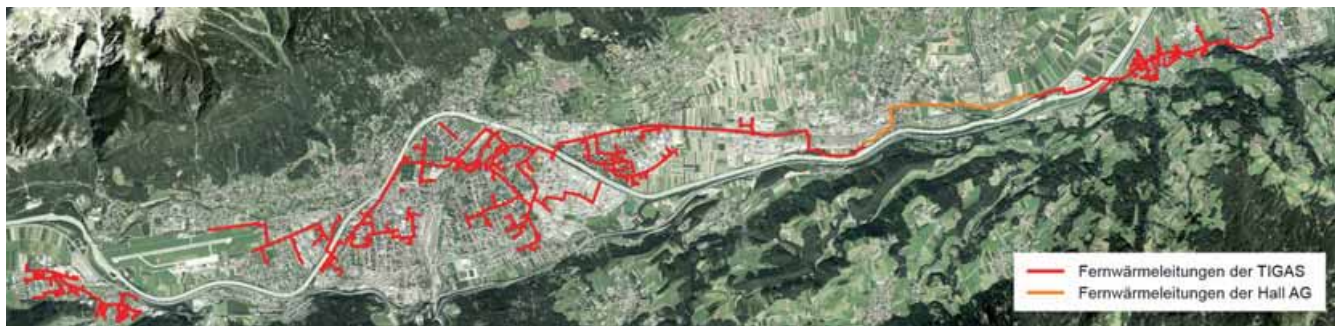
Die Fernwärmetransportschiene zwischen Innsbruck und Wattens verbindet zur Belieferung der Kunden unterschiedliche Wärmequellen.
